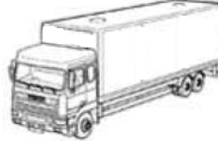
Veicoli a motore a 3 assi o + assi: 25 t se dotati di asse motore con pneumatici gemellati e sospensioni pneumatiche:
